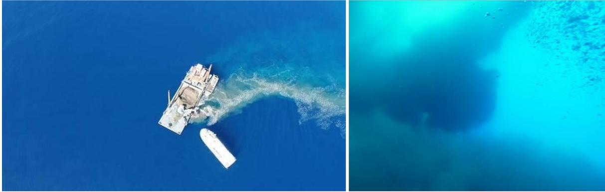
Panache formé par le déchargement du contenu d'un godet et nuage sous-jacent à 8 m de profondeur
