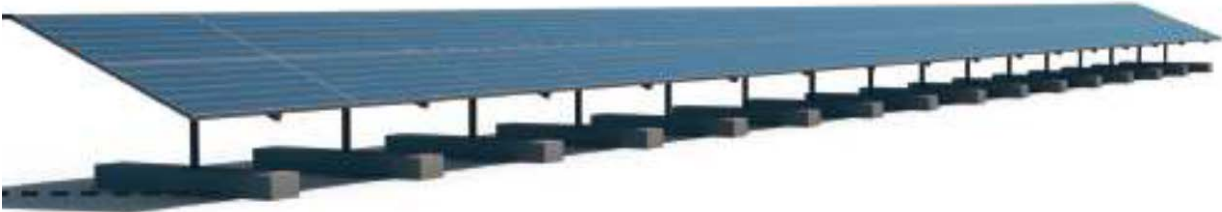
Schéma d'une table photovoltaïque, comprenant un assemblage de modules et leur structure porteuse (Source COMPOSITE)
