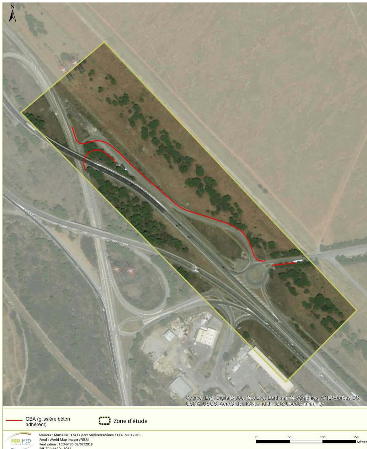
Figure 31 : Mesure R3 – Mise en place d'une GBA définitive (phase exploitation)
