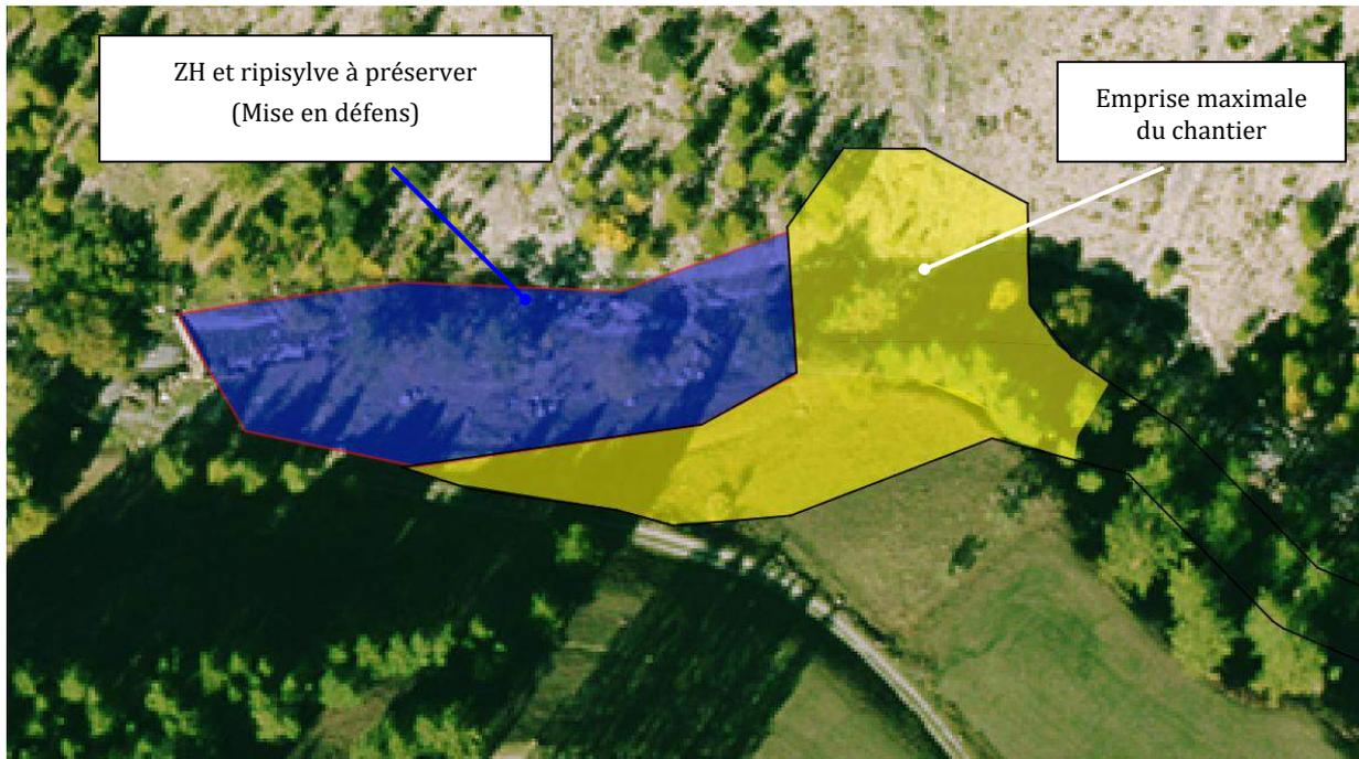
Figure 3 : Emprise maximale du chantier de prise d'eau (Source : Géoportail, UNITE)
