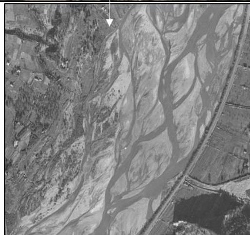
Faciès méditerranéen semi-naturel en tresse : système semi-endigué (rive gauche) situé à l'amont du pont de la Manda (1943) avant l'existence des seuils et des travaux d'extraction d'alluvions
