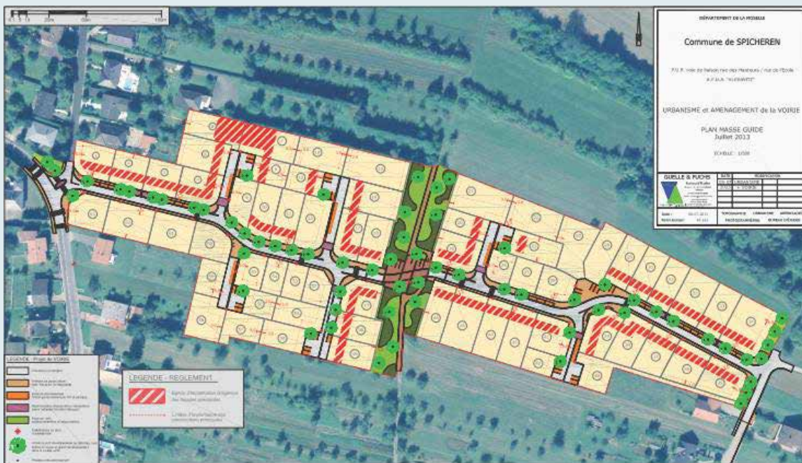
Plan-guide de la première tranche de l'opération et nouveau parcellaire après remembrement, sous forme d'AFUA. Source cabinet de géomètres-experts Guelle & Fuchs
