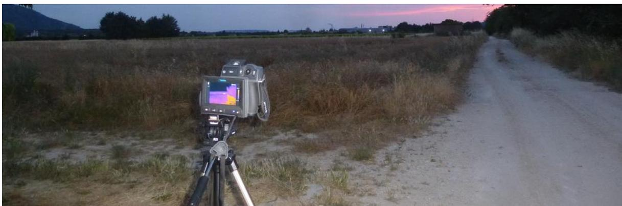
Figure 53 - Illustration de la caméra thermique FLIR T640 installée sur site (Photo : NATURALIA).
