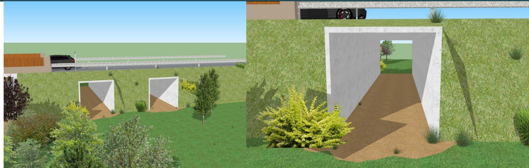
Figure 22 - Visuels de principe du traitement mixte des dalots hydrauliques (assise sédimentaire au sol ; insertion dans le remblai routier). Source : NATURALIA
