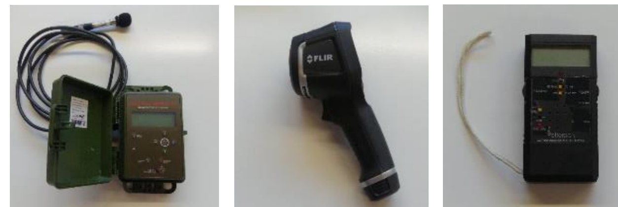
Enregistreur SM4 (gauche), caméra thermique FLIR (centre) et détecteur d'ultrason Petterson D240X (droite)
