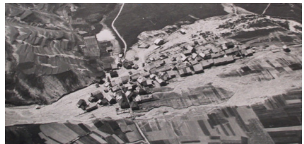
Exemples de divagations et changements de lit sous l'effet des matériaux charriés ou déposés
