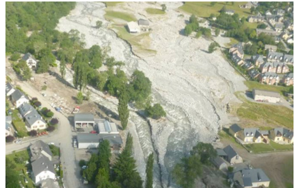
Exemple de dépôts massifs en fond de lit par charriage
