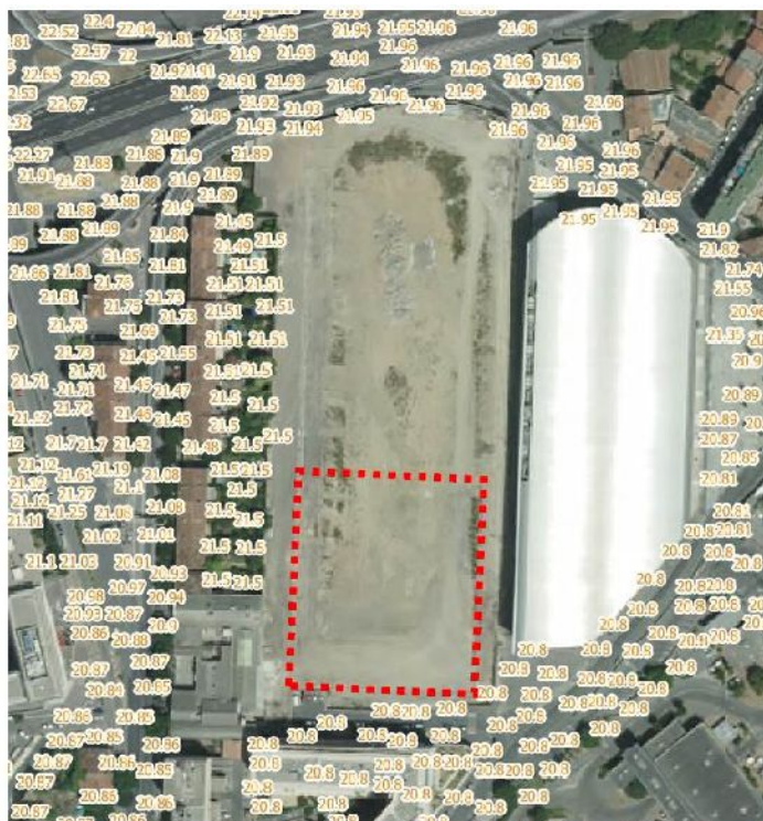
Niveau des plus hautes eaux fournies par la Direction de l'Eau et l'assainissement
