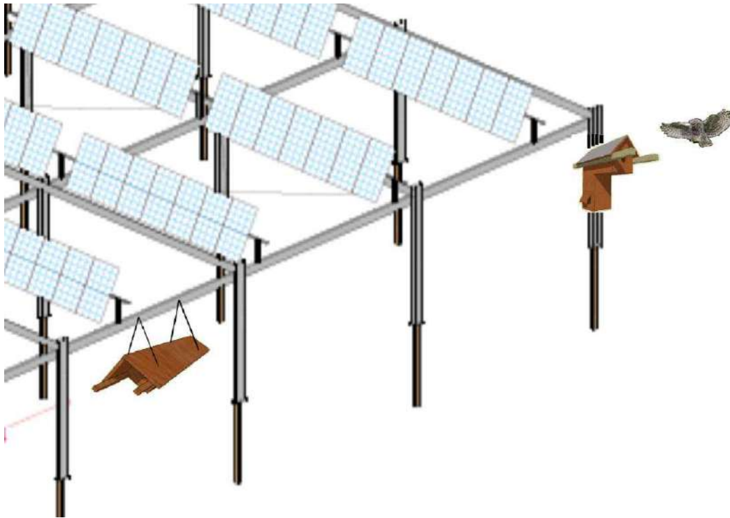
Schématisme de la mise en place des nichoirs en bordure de la structure agrivoltaïque. Taille nichoir fois 8.
