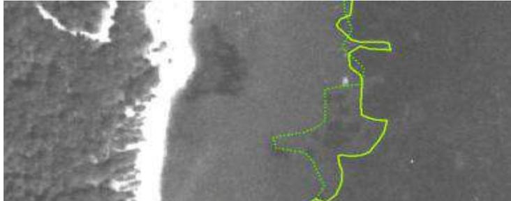
Figure 2 : Difficulté d'un levé de la limite de l'herbier, à l'aide d'une méthode linéaire en présence de taches isolées
