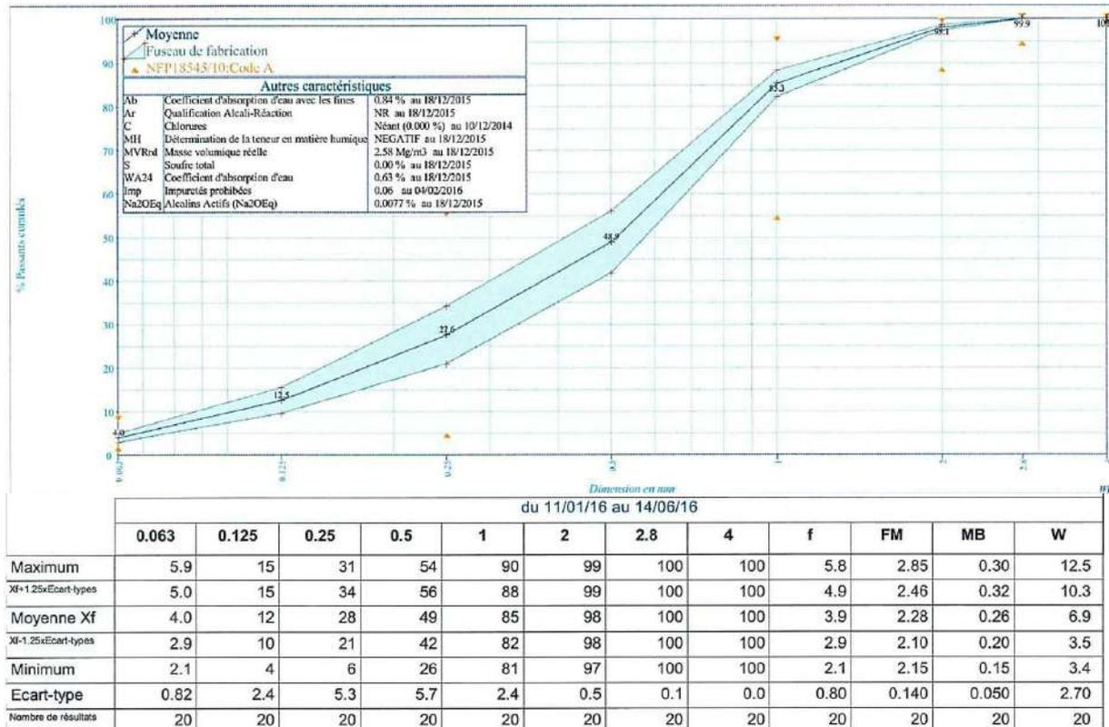
Figure 9 : Caractéristiques granulométrique du sable de rechargement
