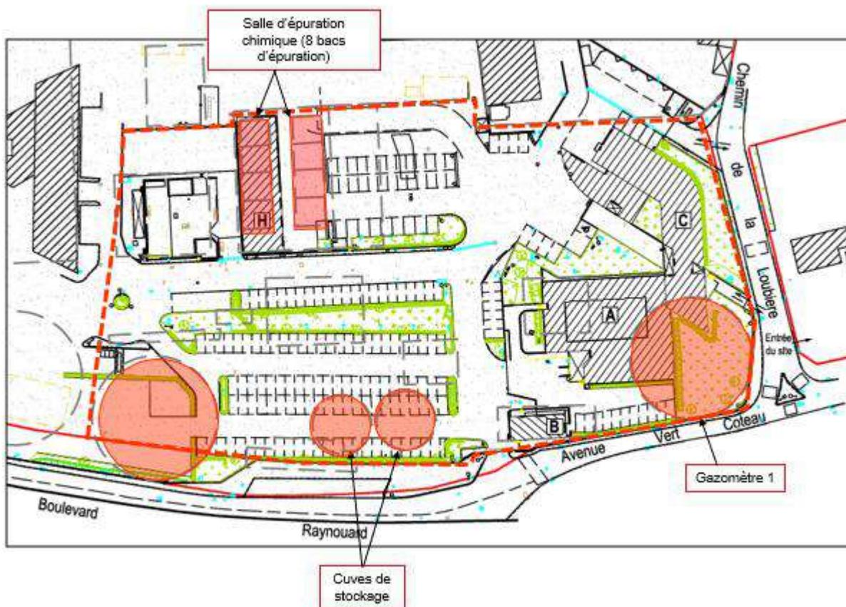
Figure 9 : Plan des ouvrages de stockage de l'AUG
