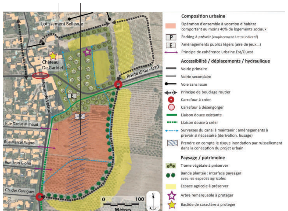
Emprise réservée pour l'urbanisation Axe d'écoulement identifié dans l'étude hydraulique
