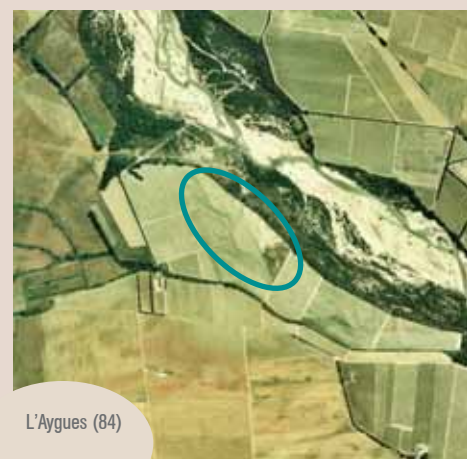
Trace d'un axe de crue sur une photographie aérienne
