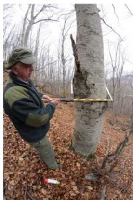
La mesure s'effectue soit à l'aide d'un compas forestier (diamètre), soit à l'aide d'un mètre ruban (circonférence) ; dans les deux cas la mesure s'effectue à hauteur de poitrine (1,3 m de hauteur) ou sous le départ de grosses charpentières (>1/3 du diamètre de l'arbre).
