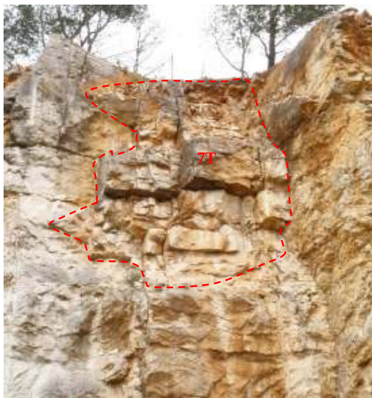
Photographies n°73 et 74 : Paquet rocheux 7T décomposé en blocs (0.2x0.2x0.2 à 0.8x0.8 à 1.2m) présentant une fissure ouverte à l'arrière
