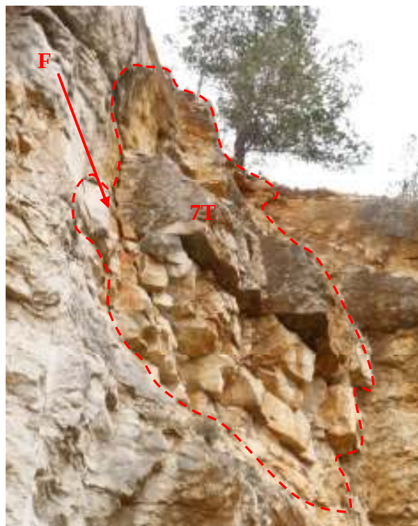
Photographies n°73 et 74 : Paquet rocheux 7T décomposé en blocs (0.2x0.2x0.2 à 0.8x0.8 à 1.2m) présentant une fissure ouverte à l'arrière
