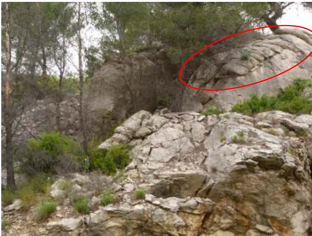
Photographie n°26 : Masse Ecaillage superficiel de la frange supérieure de la barre calcaire
