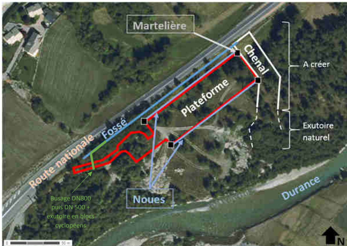
FIGURE 1 : GESTION DES EAUX PLUVIALES
