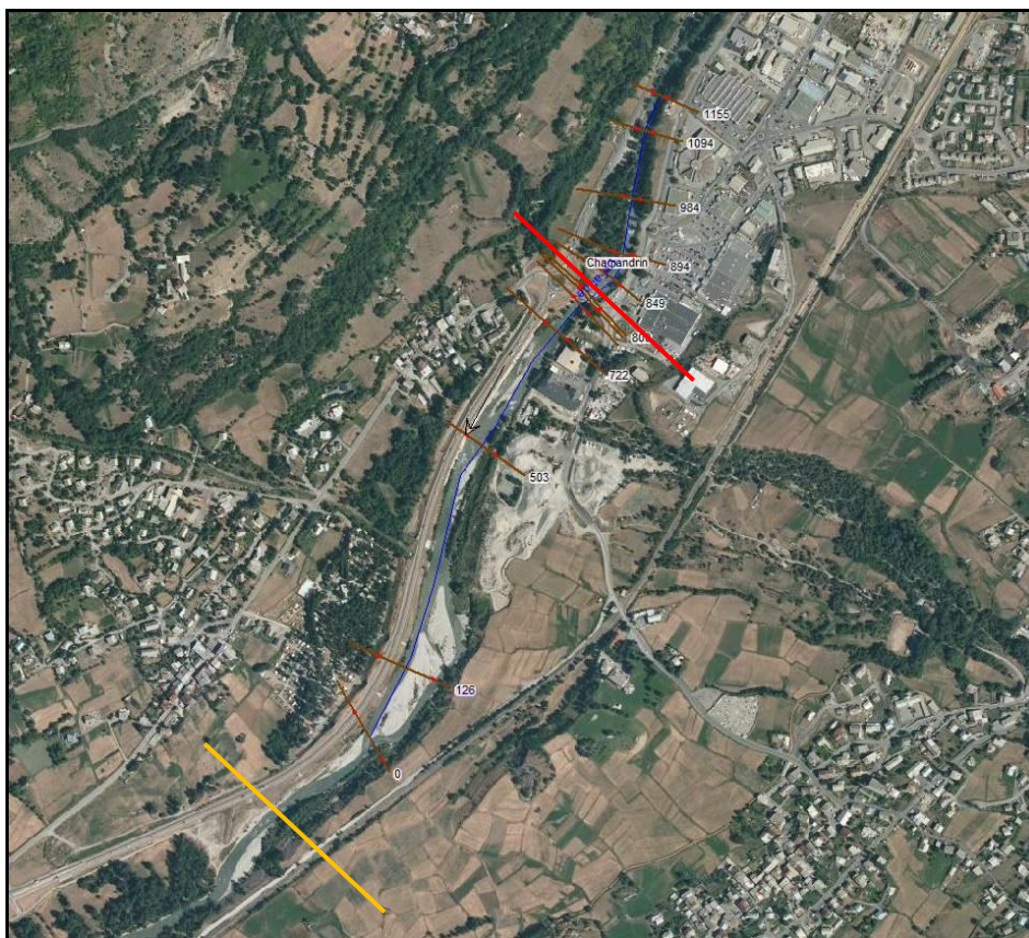
Figure 17 : illustration modèle 1D et section en amont du pont (en rouge) ; section en amont de la plaine (en orange)
