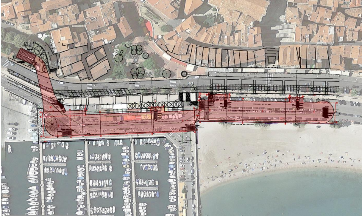
Figure 10 Insertion du parking souterrain entre la Vieille Ville de Menton et le bassin portuaire du Vieux-Port. A droite : la plage des Sablettes.
