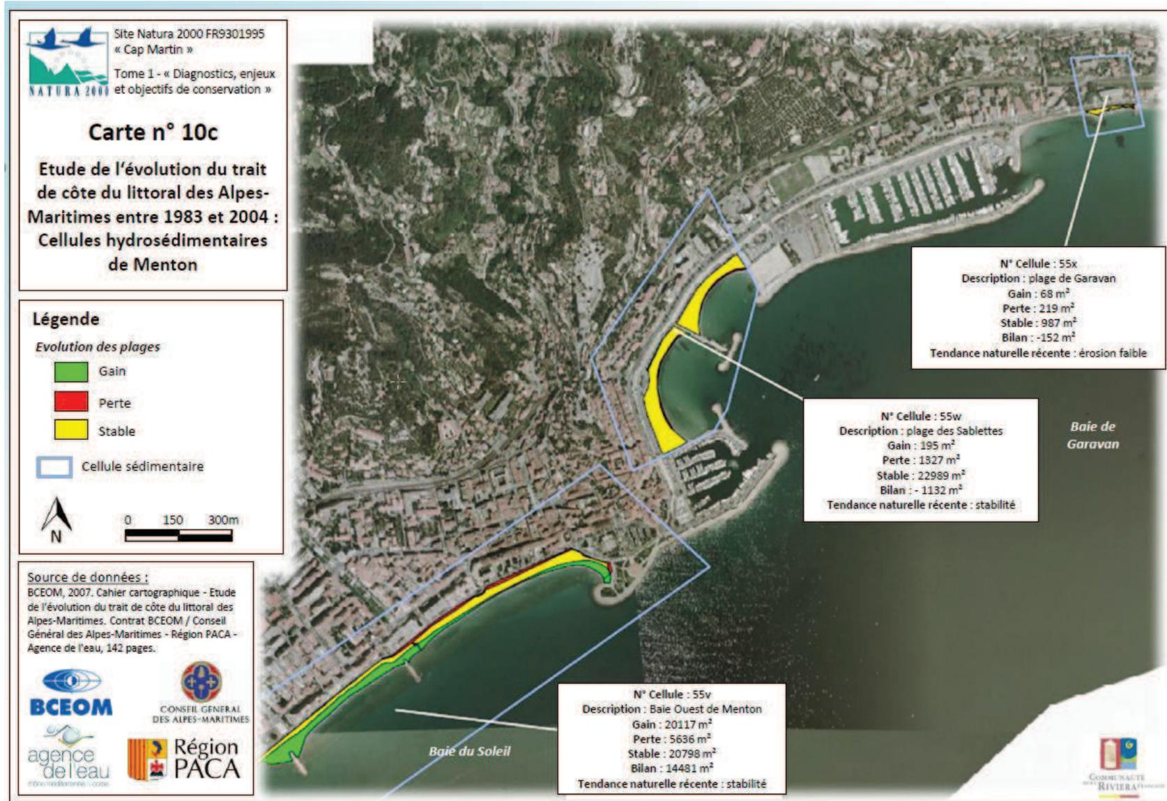
La plage des Sablettes est devenue une plage « artificielle » protégée de mouvements sédimentaires par l'épi de protection ouest accolé à la digue du Vieux-Port, l'épi central terminé par un brise-lames et la digue du port de plaisance de Garavan. Ces ouvrages de protection expliquent la tendance actuelle à la stabilité de la plage.
