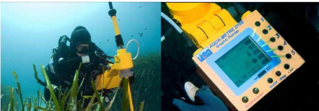
Figure 16 : pointeur acoustique de l'aquamètre D100
