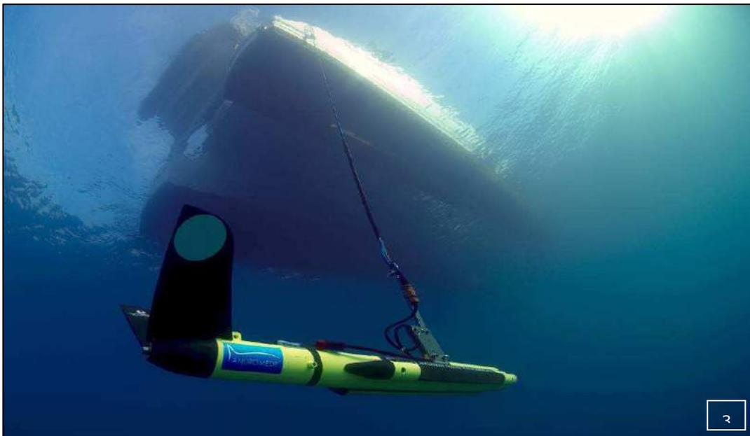
**Figure 11 : Levé sonar latéral Klein 3900 (1 : DGPS, micro-ordinateur avec logiciel SonarPro et enregistreur numérique ; 2 : retour contrôle pour pilote ; 3 poisson relié au bateau par le câble électroporteur**
