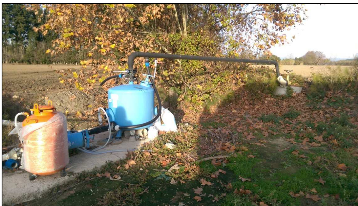
Figure 6 – Arrivée de l'eau depuis le canal et système de filtration (associé au fertilisateur) 17/11/2015
