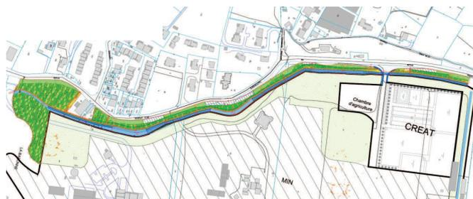
La phase 1 consistera à aménager la voie d'accès au CREAT et à la chambre d'agriculture et à réaliser les infrastructures nécessaires pour le raccordement aux réseaux. Un accès de chantier sera mis en place pour assurer la traversée du canal des Iscles. Il comprendra le busage provisoire du canal sur une longueur suffisante pour permettre le passage des engins en toute sécurité.
