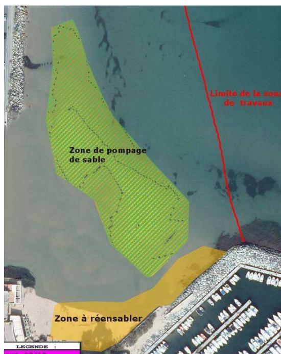
**Figure 14** : localisation de dépôt du sable sur la plage lors du pompage
