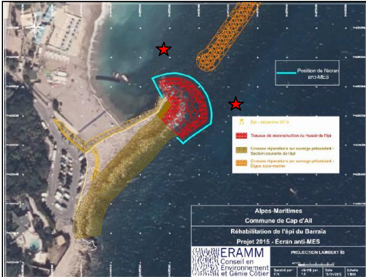
Figure 16: Position de l'écran anti-MES pour les travaux relatifs au musoir de l'épi (ERAMM, 01-2015) Stations de mesure de turbidité :
