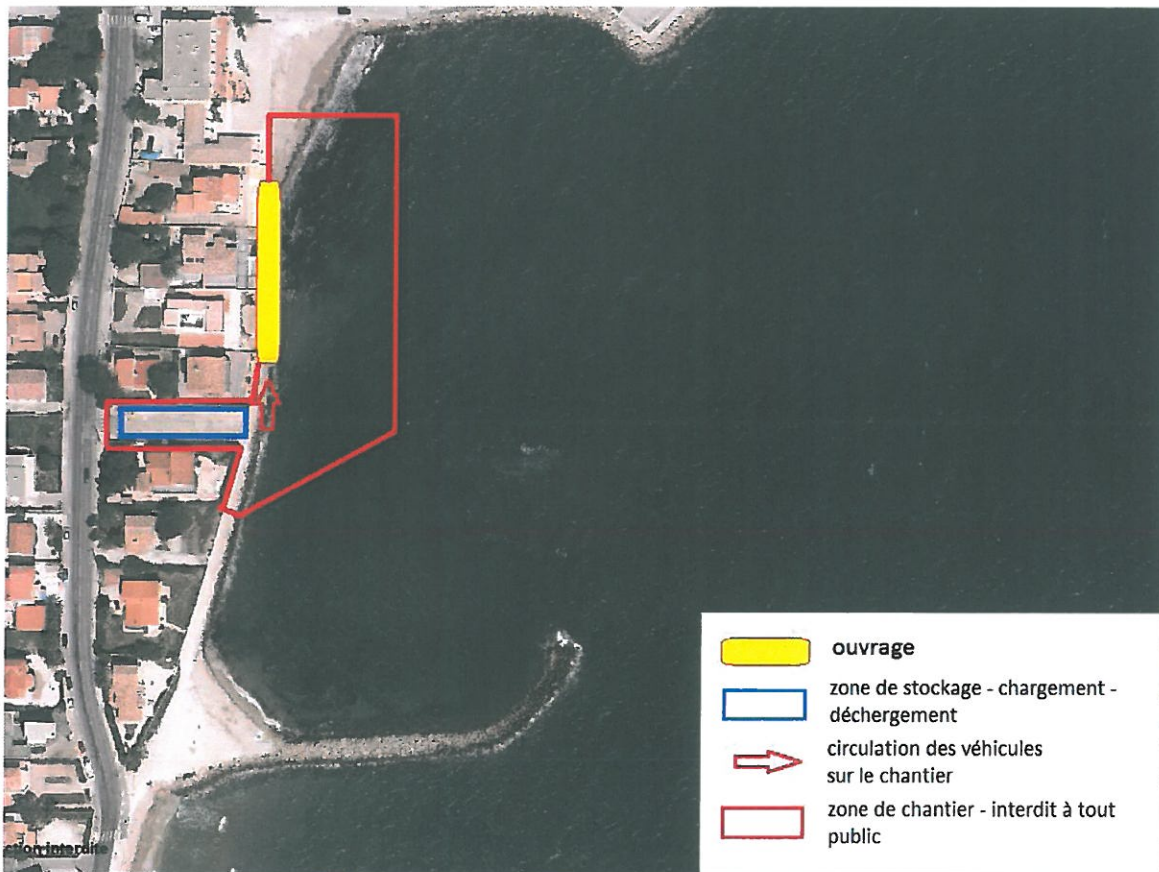
Emprise du chantier
