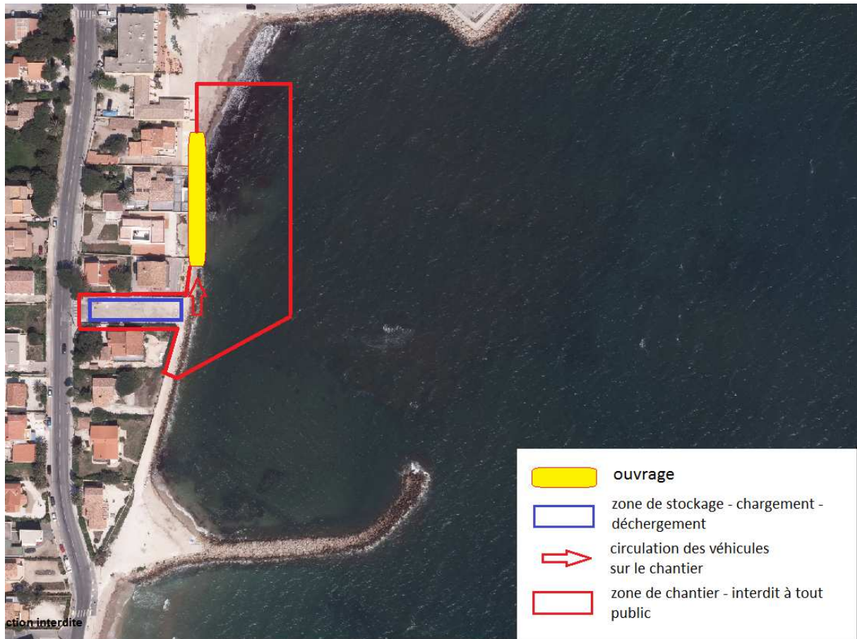
Figure 13 : Emprise du chantier
