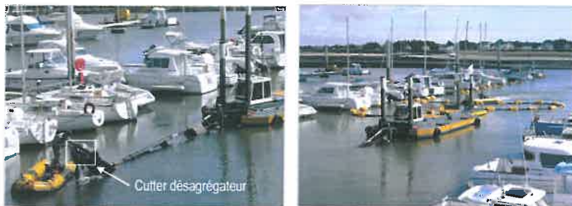
Figure 1 : Exemple de Drague Aspiratrice Stationnaire (DAS)
