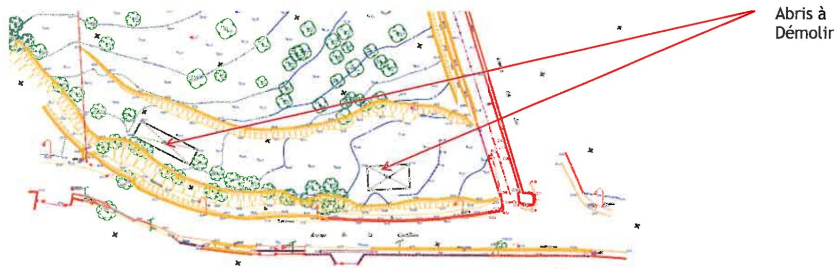
La démolition des ouvrages existants comprendra les fondations, parois en sous œuvre (sous-sol) et en élévations, les ouvrages horizontaux, équipements organiques et spécialisés, etc. ainsi que le concassage des matériaux.
