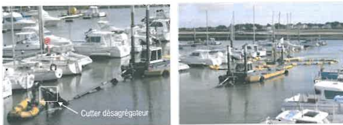
Figure 1 : Exemple de Drague Aspiratrice Stationnaire (DAS)
