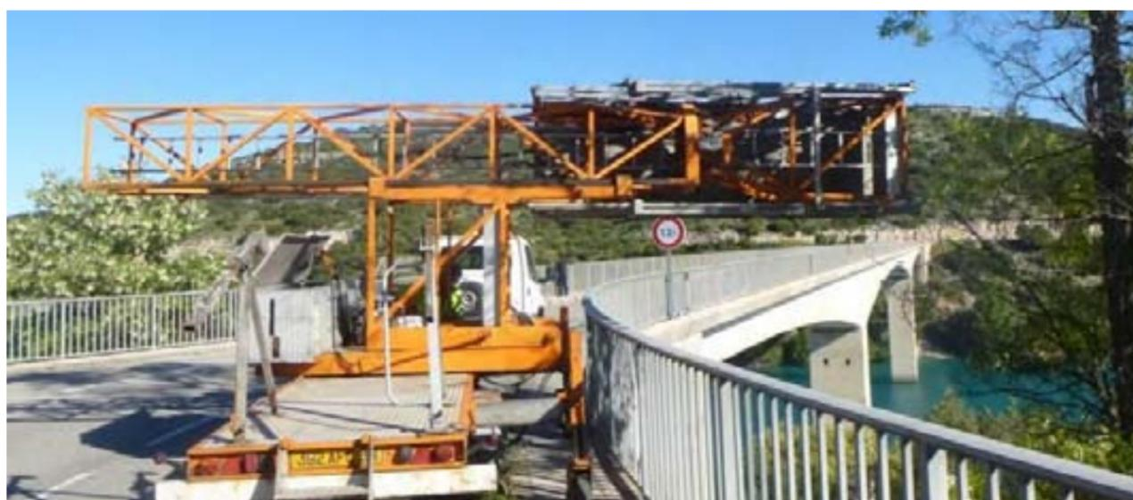
Figure 9 : Illustration de la nacelle inversée depuis la chaussée (Photo : E. Durand / NATURALIA)
