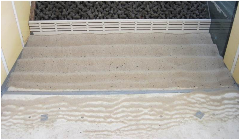
Photographie 4 - Déformation du fond mobile dû à la réflexion de la houle sur les palplanches de la solution « Écopodes + palplanches » du profil hélistation
