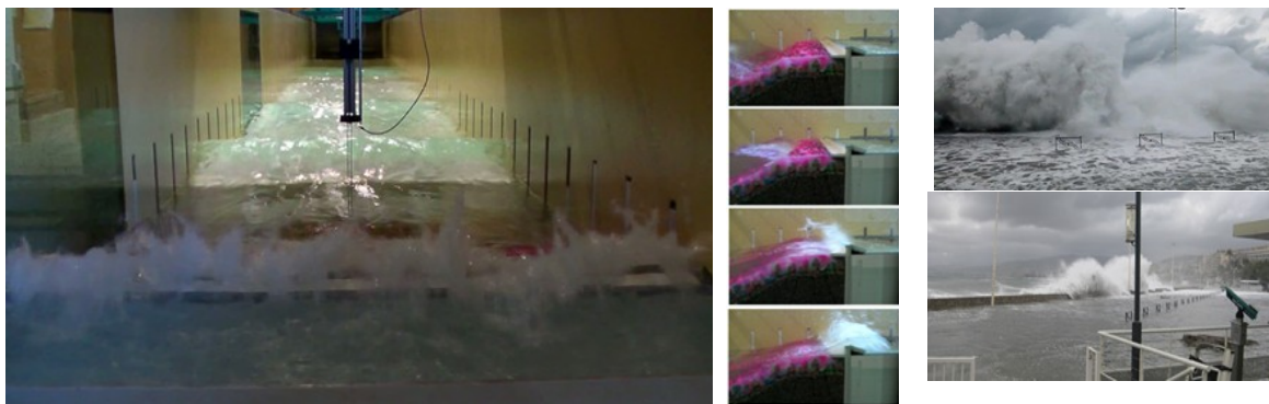
Photographie 3 - Illustration de la campagne d'essais sur l'état actuel de la digue Laubeuf avec comparaison par rapport aux images des tempêtes modélisées
