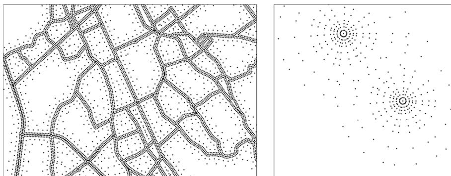
**Figure 26: Exemple de positionnement des points de calculs pour le traitement des sources linéaires (gauche) et des sources ponctuelles (droite)**
