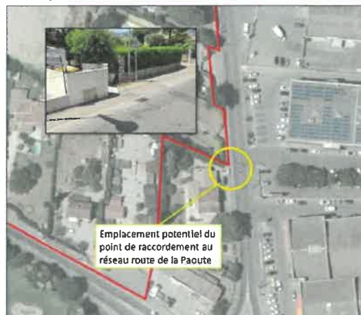
Rejet du BV 2 au réseau EP route de la Paoute
