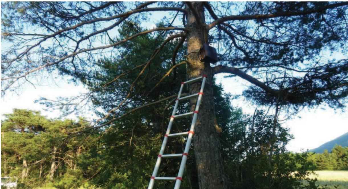
**Figure 6 : Installation d'un détecteur à ultrasons (boîte métallique protectrice) à l'aide d'une échelle télescopique**
