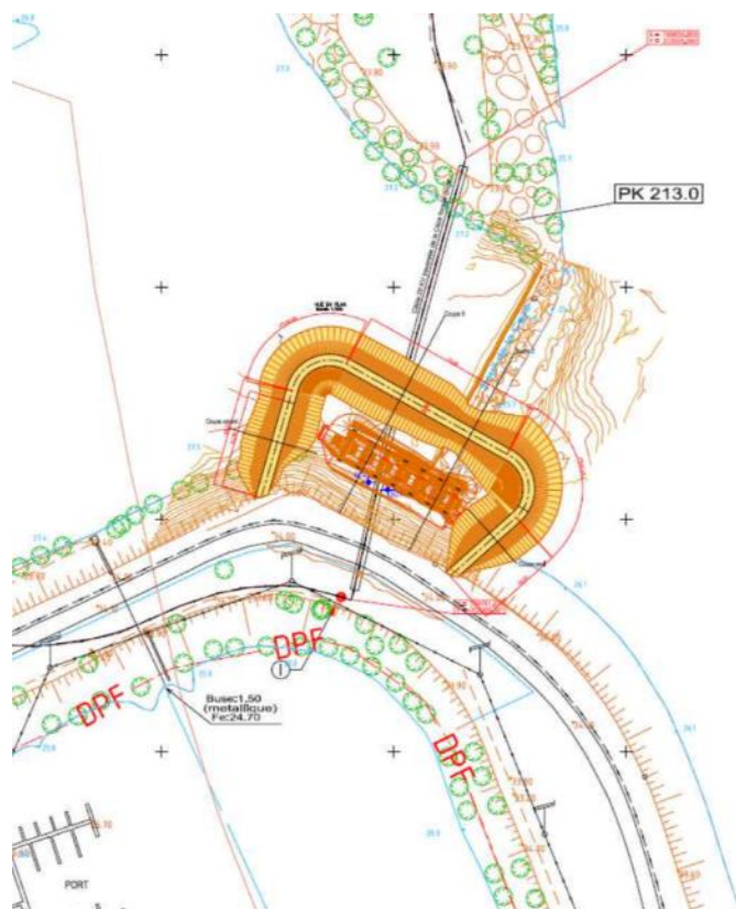
Figure 9 : Implantation du batardeau de protection du chantier de construction de la nouvelle passe à poissons
