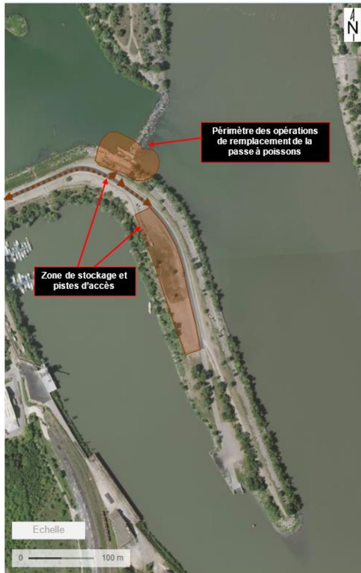
Figure 10 : Chantier de remplacement de la passe à poissons (© Géoportail 2017)
