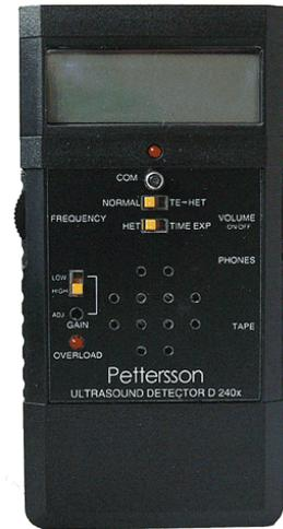
**Détecteur Petterson Elektronik D240x (modèle avec hétérodyne et expansion de temps)** - Source : [batmanagement.com](http://batmanagement.com)
