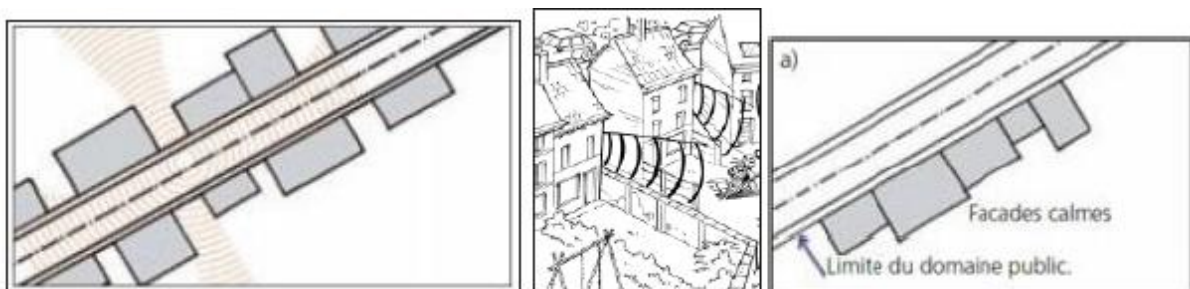
Problème de front de bâtiments non continu en bordure de voie
