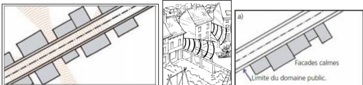
Problème de front de bâtiments non continu en bordure de voie
