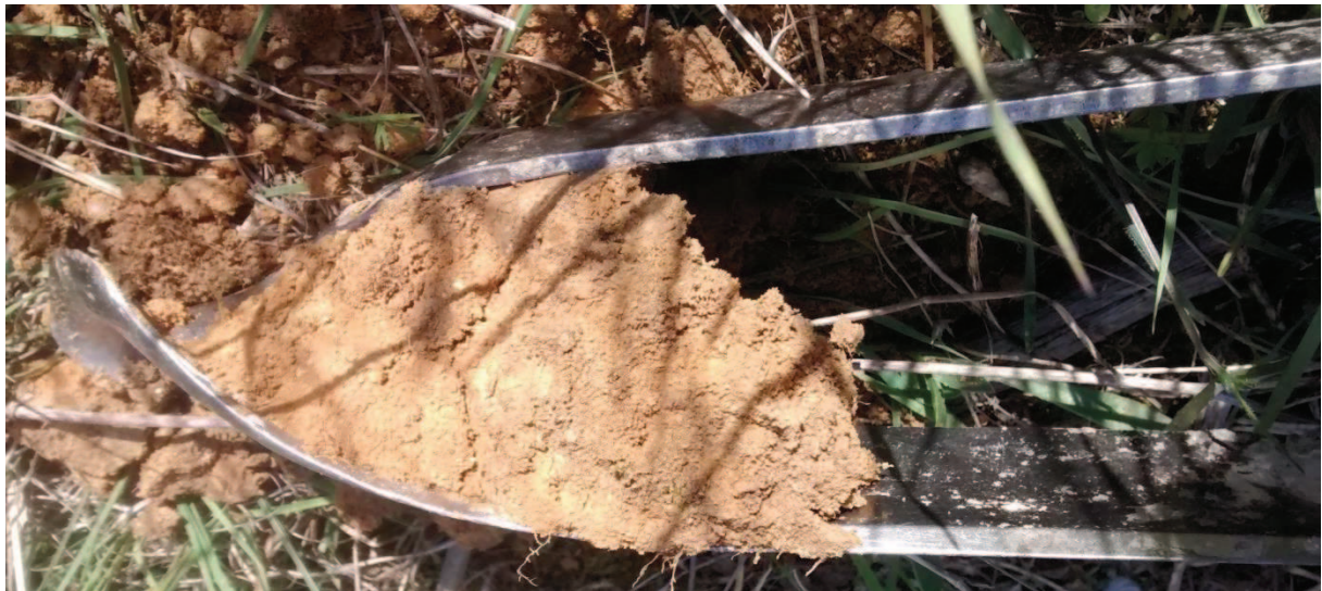
Figure 7 : Illustration des sondages pédologiques (Photo prise sur site : R. Prunier, Naturalia)
