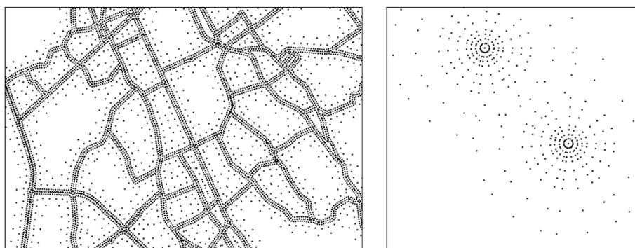
**Figure 28: Exemple de positionnement des points de calculs pour le traitement des sources linéaires (gauche) et des sources ponctuelles (droite)**
