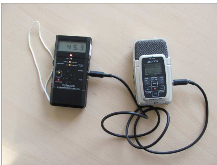
PETTERSSON D240X couplé à un enregistreur numérique
