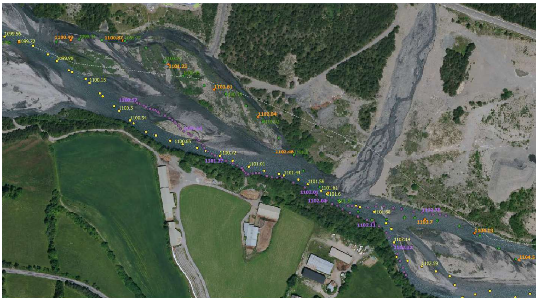
Figure 16 : cote topo des profils en long (niveau d'eau), en vert sept. 2007, en jaune sept. 2015, en violet 30/10/2019, et en orange profil fond objectif
