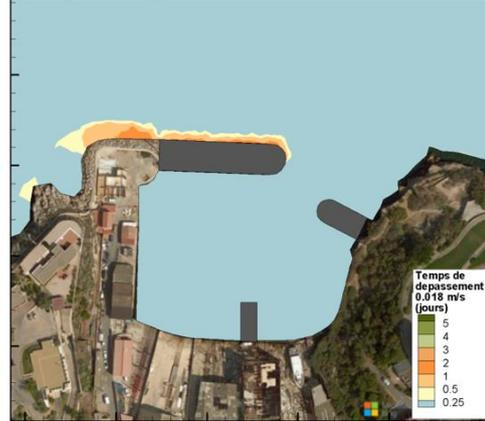
Figure 36 – Temps de dépassement de la vitesse de cisaillement pour les 2 seuils de mise en mouvement (D50 entre 300 et 500  $\mu\text{m}$  à gauche et D50 entre 650 et 700  $\mu\text{m}$  à droite– Scénario « Mistral »
