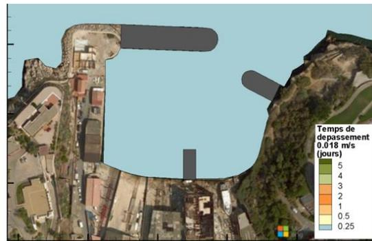
Figure 37 – Temps de dépassement de la vitesse de cisaillement pour les 2 seuils de mise en mouvement (D50 entre 300 et 500  $\mu\text{m}$  à gauche et D50 entre 650 et 700  $\mu\text{m}$  à droite– Scénario « Marin »
